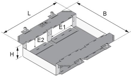
Bei den Bauelementen UGE3 VRK handelt es sich um Geräteeinsätze mit seitlichen Blenden, die in Einbaueinheiten aus Kunststoff, geeignet für bis zu drei Gerätebecher, geschraubt werden können. Die Einsätze lassen sich mit maximal vier Installationsgeräten der Größe 45x45 mm und 6 Dateneinzeljacks bestücken. Sie sind aus sendzimir-feuerverzinktem Stahlblech gefertigt.
