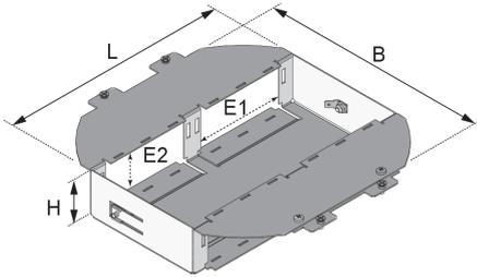
Bei den Bauelementen UGE3 RE handelt es sich um Geräteeinsätze mit seitlichen Blenden, die in runde Einbaueinheiten aus Edelstahl, geeignet für maximal drei Gerätebecher, geschraubt werden können. Die Einsätze lassen sich mit bis zu vier Installationsgeräten der Größe 45x45 mm und bis zu 6 Dateneinzeljacks bestücken. Sie sind aus sendzimir-feuerverzinktem Stahlblech, nach DIN EN 10346, gefertigt.
