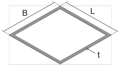
Bei den Bauelementen UGD V handelt es sich um quadratisch, einseitig selbstklebende Gummidichtungen. Diese Zubehörteile aus dem Sortiment der Unterflursysteme werden in Edelstahl-Einbaueinheiten geklebt und dienen dort der zuverlässigen Trittschallentkopplung und sicheren Abdichtung der Einbaueinheiten vor Schmutz und Feuchtigkeit. Das Produkt wird aus strapazierfähigem Gummi gefertigt und ist mit einer Breite und Länge von 252 mm und einer Materialstärke von 2 mm erhältlich.
