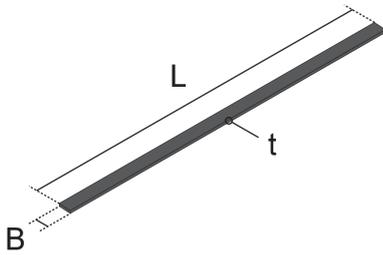
UGD 10 ist ein einseitig selbstklebendes Streifengummi. Es ist ein Zubehörteil aus dem Sortiment der Unterflursysteme und dient der sicheren Abdichtung von Kanalunterteilen bzw. der aufgelegten Deckel. Das Produkt wird aus strapazierfähigem Gummi gefertigt und ist als 10000 mm lange Rollware erhältlich. Das Bauteil entspricht der DIN EN 50085 – der europäischen Norm für Elektroinstallationskanalsysteme, und ist vom VDE geprüft und zertifiziert.
