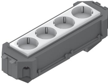
Bei den Bauelementen UG45WI-4 handelt es sich um vorkonfektionierte Gerätebecher. Sie sind mit einem 3-poligen Snap-In-Gerätestecker des Herstellers Wieland, einer vorverdrahteten Steckdose (4-fach) und allen Abdeckungen und Montagematerialien ausgestattet. Die Gerätebecher können im Bodenbereich mit 3-poligen Anschlussleitungen mit Stecker und Buchse verbunden werden. Sie sind aus Acrylnitril-Butadien-Styrol-Copolymerisat gefertigt.
