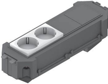
Bei den Bauelementen UG45WI-2 handelt es sich um vorkonfertierte Gerätebecher. Sie sind mit einem 3-poligen Snap-In-Gerätestecker des Herstellers Wieland, einer vorverdrahteten Steckdose (2-fach) und allen Abdeckungen und Montagematerialien ausgestattet. Die Gerätebecher können im Bodenbereich mit 3-poligen Anschlussleitungen mit Stecker und Buchse verbunden werden. Sie sind aus Acrylnitril-Butadien-Styrol-Copolymerisat gefertigt.
