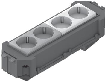
Bei den Bauelementen UG45WI-2-2 handelt es sich um vorkonfertierte Gerätebecher. Sie sind mit einem 3-poligen Snap-In-Gerätestecker des Herstellers Wieland, einer vorverdrahteten Steckdose (2x 2-fach) und allen Abdeckungen und Montagematerialien ausgestattet. Die Gerätebecher können im Bodenbereich mit 3-poligen Anschlussleitungen mit Stecker und Buchse verbunden werden. Sie sind aus Acrylnitril-Butadien-Styrol-Copolymerisat gefertigt.
