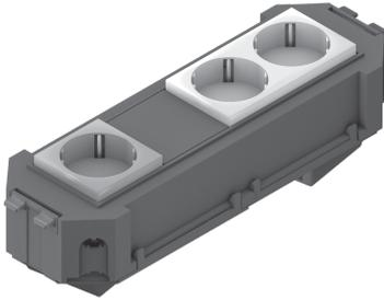
Bei den Bauelementen UG45WI-2-1 handelt es sich um vorkonfertierte Gerätebecher. Sie sind mit einem 3-poligen Snap-In-Gerätestecker des Herstellers Wieland, einer vorverdrahteten Steckdose (1-fach und 2-fach) und allen Abdeckungen und Montagematerialien ausgestattet. Die Gerätebecher können im Bodenbereich mit 3-poligen Anschlussleitungen mit Stecker und Buchse verbunden werden. Sie sind aus Acrylnitril-Butadien-Styrol-Copolymerisat gefertigt.
