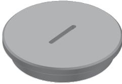
Bei den Bauelementen UETD WD handelt es sich um Tubusdeckel, welche auf einen bodenübertagenden Leitungsauslass, den Tubus UET WD, aufgeschraubt werden. Sie besitzen auf der Oberseite einen länglichen Auslass für die Strom- und Datenleitungen. Dieses Zubehör aus dem Sortiment der Einbaueinheiten ist in der Farbe Edelstahl massiv aus den Werkstoffen Edelstahl oder aus massivem Messing gefertigt.
