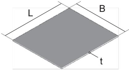
Bei den Produktlösungen UEKD V handelt es sich um Zubehör aus dem Portfolio der Unterflurssysteme. Diese eckigen Deckeinlagen werden in viereckige Kunststoffklappdeckel eingesetzt, um dort Bodenaussparungen zu verringern. Die Zubehörelemente werden aus hochwertigem Karton gefertigt und besitzen eine Breite von 169 mm und eine Länge von 210 mm. Sie sind in einer Materialstärke von 3 mm erhältlich.
