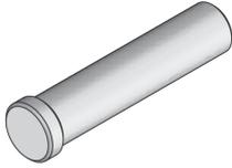
Bei den Produktlösungen UEK3 ST handelt es sich um Scharnierstifte. Diese Bauelemente gehören zum Sortiment der Unterflursysteme. Die Stifte dienen einer flexiblen Verbindung zwischen den Gerätebechern und den Deckeln der Einbaueinheiten. Sie werden aus sendzimir-feuerverzinktem Stahlblech nach DIN EN 10346 gefertigt.
