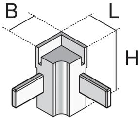
Bei den Produktlösungen UEBSV handelt es sich um drehbare Eckverbinder für estrichbündige Kanäle. Die Verbinder dienen im Montageprozess dem Erstellen eines Formteiles. Dabei sind sie, je nach Drehrichtung als Innen- oder Außeneck, einsetzbar. Die Bauelemente sind aus dem Kunststoff Polyamid gefertigt und in einer Höhe von 50 oder 57 mm, einer Breite und Länge von 28 mm erhältlich.
