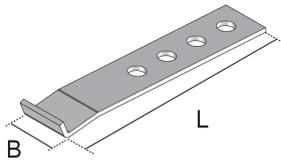
Bei den Bauelementen UEBSEA handelt es sich um Estrichanker, welche in die Außenprofile estrichbündiger Kabelsysteme eingerastet werden. Diese Artikel werden eingesetzt, um den Verbund zwischen Kanälen und Estrich zu festigen. Auf diese Weise kann späteren Rissbildungen entgegengewirkt werden. Die Anker werden aus sendzimir-feuerverzinktem Stahlblech nach DIN EN 10346 hergestellt. Pro Kanaleinheit enthält jede Lieferung vier Estrichanker in einer Breite von 20 mm und Länge von 104 mm.
