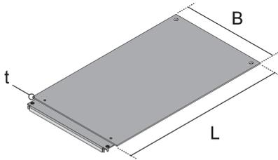
Bei den Bauelementen UEBSD handelt es sich um Blinddeckel für den Einsatz bei estrichbündigen Kanalsystemen. Die Produktlösungen sind aus sendzimir-feuerverzinktem Stahlblech nach DIN EN 10346 gefertigt. Sie werden werkseitig mit den Quertraversen UEBSQT fest verschraubt und in einer Breite von 200 bis 500 mm, einer Länge von 500 mm und einer Materialstärke von 3 mm geliefert. Die Blinddeckel haben eine VDE/TÜV-Zulassung gemäß DIN EN 50085 erhalten.
