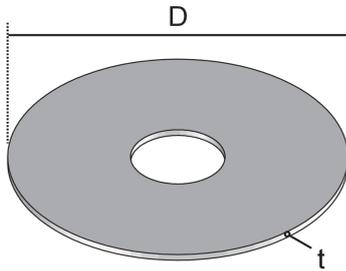
Bei den Bauelementen UEBDME R handelt es sich um runde Deckeinlagen. Diese Zubehörteile werden als Füllstück zur Verringerung der Bodenbelageeinlagetiefe in Edelstahltubusauslasskassetten eingesetzt, welche mit bis zu drei Gerätebechern bestückt werden können. Die weißen Deckeinlagen aus dem Sortiment der Einbaueinheiten für Unterflursysteme sind aus hochwertigem Polyvinylchlorid Hartschaum gefertigt. Sie sind mit einem Durchmesser von 297 mm und einer Materialstärke von 6,0 mm erhältlich.
