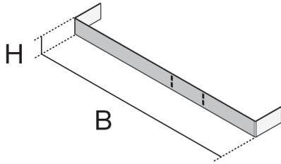
Bei dem Bauelement UE handelt es sich um Endstücke, die bei der Montage estrichüberdeckter Unterflurkanäle eingesetzt werden. Durch das Umbiegen an der perforierten Linie auf dem Bauteil können die Endstücke in die Kanälenden geschoben werden und bilden dort einen sicheren Verschluss. Dabei sind sie passend für Kanalbreiten von 190, 250 und 350 mm ausgelegt. Die Endstücke werden aus sendzimir-feuerverzinktem Stahlblech nach DIN EN 10346 gefertigt.
