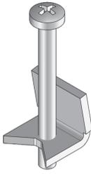
Bei den Produktlösungen UDKS R 4 handelt es sich um Universalkrallensets aus dem Portfolio der Unterflursysteme. Diese Krallensets werden in die Rahmen von runden Einbaueinheiten aus Kunststoff eingehängt und gewährleisten dort eine feste Verbindung zwischen den runden Klappdeckeln und den Rahmen der Einheiten. Dieses Zubehör besteht aus sendzimir-feuerverzinktem Stahlblech gemäß DIN EN 10346 und wird als Set aus vier Krallen mit einem Klemmbereich von 30 - 50 mm geliefert.
