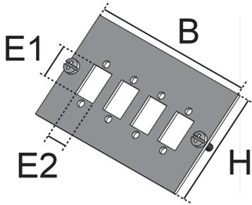
Bei den Bauelementen UDEP SCS handelt es sich um Einbauplatten aus dem Sortiment der Unterflursysteme. Die Platten werden in Datengeräteträger eingeschraubt und dienen dort der Aufnahme von bis zu 4 Einzelinstallationsgeräten zur Lichtwellenleitung des Typs SC-Simplex und LC-Duplex. Die Einbauplatten sind aus einseitig schwarz beschichtetem Aluminium gefertigt und können mit dem Einbaumaß E1 von 13,5 mm und E2 von 9,6 mm erworben werden.
