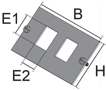
Bei den Bauelementen UDEP KR handelt es sich um Einbauplatten aus dem Sortiment der Unterflursysteme. Die Platten werden in Datengeräteträger eingeschraubt und dienen dort zur Aufnahme von bis zu 2 Datenjacks von ADC KRONE oder Stecktechnikkomponenten anderer Hersteller wie Dätwyler, Telegärtner oder Brand-Rex. Die Einbauplatten sind aus einseitig schwarz beschichtetem Aluminium gefertigt und können mit dem Einbaumaß E1 von 19,4 mm und E2 von 14,8 mm erworben werden.
