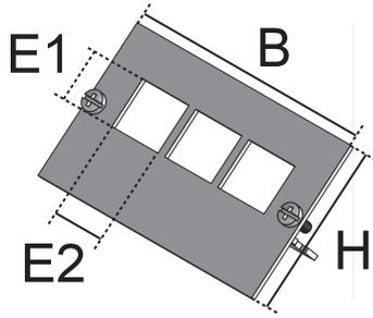
Bei den Bauelementen UDEP KEL handelt es sich um Einbauplatten aus dem Sortiment der Unterflursysteme. Die Platten werden in Datengeräteträger eingeschraubt und dienen dort zur Aufnahme von bis zu 3 Buchsen des Herstellers LEONI Kerpen. Die Einbauplatten sind aus einseitig schwarz beschichtetem Aluminium gefertigt und können mit dem Einbaumaß E1 von 14,2 mm und E2 von 16,2 mm erworben werden.
