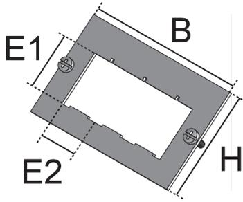
Bei den Bauelementen UDEP COR handelt es sich um Einbauplatten aus dem Sortiment der Unterflursysteme. Die Platten werden in Datengeräteträger eingeschraubt und dienen dort zur Aufnahme von maximal 3 LANscape-Datenjacks des Herstellers Corning. Die Einbauplatten sind aus einseitig schwarz beschichtetem Aluminium gefertigt und können mit dem Einbaumaß E1 von 22,8 mm und E2 von 18 mm erworben werden.
