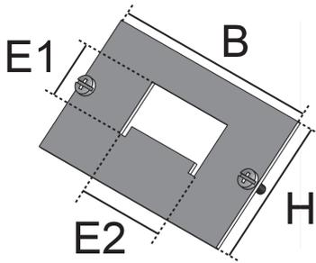
Bei den Bauelementen UDEP 5PCOM handelt es sich um Einbauplatten aus dem Sortiment der Unterflursysteme. Die Platten werden in Datengeräteträger eingeschraubt und dienen dort zur Aufnahme einer 5-poligen Snap-in-Steckverbinderbuchse oder eines Snap-in-Stecker mit 400 V und 32 A. Die Einbauplatten sind aus einseitig schwarz beschichtetem Aluminium gefertigt und können mit dem Einbaumaß E1 von 18,5 mm und E2 von 31,8 mm erworben werden.
