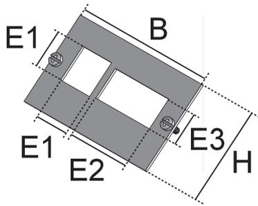
Bei den Bauelementen UDEP 3PK handelt es sich um Einbauplatten aus dem Sortiment der Unterflursysteme. Die Platten werden in Datengeräteträger eingeschraubt und dienen dort zur Aufnahme von bis zu drei 2-poligen Snap-in-Steckverbinderbuchsen von Wieland mit 250V und 16 A. Die Einbauplatten sind aus einseitig schwarz beschichtetem Aluminium gefertigt und können mit dem Einbaumaß E1 von #AW.E1# mm, E2 von 33 mm und E3 von 15.6 mm erworben werden.
