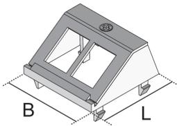
Bei den Bauelementen UDAP45-KS handelt es sich um 2-fache Datendosenabdeckungen aus dem Sortiment der Installationsgeräte aus dem Unterflursortiment. Sie werden in einem Winkel von 30° in Einbauplatten eingesetzt. Die 19,50x14,7 mm großen Einbauöffnungen lassen sich anschließend mit zwei Keystone-Modulen bestücken. Die Daten-Abdeckungen sind aus hochwertigem Polyamid in der Farbe Schwarz gefertigt.
