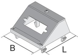
Bei den Bauelementen UDAP45-DVI handelt es sich um 1-fache Datendosenabdeckungen aus dem Sortiment der Installationsgeräte für Unterflursysteme. Sie werden in einem Winkel von 35° in die Anschlussdosen gesteckt. In ihre Einbauöffnungen mit den Maßen 11,4x28 mm lassen sich anschließend 45x45 mm große Steckverbinder des Typs DVI aufnehmen. Die Abdeckungen sind aus hochwertigem Polyamid in der Farbe Schwarz gefertigt.
