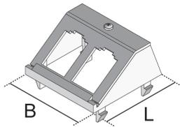
Bei den Bauelementen UDAP45-BTR handelt es sich um 2-fache Datendosenabdeckungen aus dem Sortiment der Installationsgeräte für Unterflursysteme. Sie werden in einem Winkel von 30° in Einbauplatten eingesetzt. Die 19,35/21,55x14,85 mm großen Einbauöffnungen lassen sich anschließend mit zwei BTR-Modulen bestücken. Die Daten-Abdeckungen sind aus hochwertigem Polyamid in der Farbe Schwarz gefertigt.
