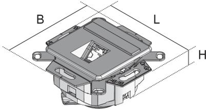
Bei den Bauelementen UDAE CAT6 handelt es sich um Datenanschlussdosen mit ein, zwei oder drei Steckplätzen für 8-polige Stecker (RJ45). Sie besitzen eine abbrechbare Tragringausführung und ein Zentralstück mit einer Stecköffnung für 8-polige Stecker (RJ45). Die Anschlussdosen lassen sich schräg nach unten geneigt in Gerätebecher einschrauben. Sie werden aus Polycarbonat in der Farbe Perlweiß (ähnlich RAL1013) gefertigt.
