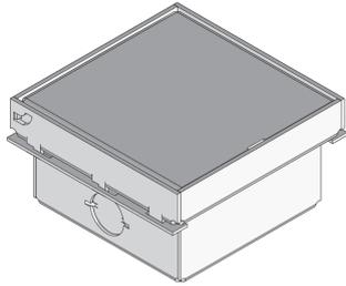
Eckige Reinigungssteckdose aus Edelstahlblech mit Stoßkante und plane Kabelaussch-Kassette. Plane Oberfläche gestrahlt. Inkl. weißer 1-facher Schutzkontaktsteckdose. Als nivellierbare Einheit mit Kassettendeckel, Aufnahmegehäuse aus Stahlblech. Zum direkten Einbau in Estrichböden. Für Räume mit geringem Fußbodenaufbau und nass gepflegten Bodenbelägen geeignet. Ausgelegt für Büroverkehrslasten.
