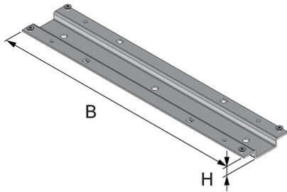
Das Bauteil UBSFQTF ist eine Quertraverse für den Estrichbündigen Kanal UBSF. Sie dient der Befestigung von Deckeln und gleichzeitig zur Aufnahme von Lasten sowie zur Unterstützung von Deckelstößen bei Formteilen. Die Quertraverse ist aus feuerverzinktem Stahlblech gefertigt und in verschiedenen Breiten erhältlich. Das Bauteil entspricht der DIN EN 50085 – der europäischen Norm für Elektroinstallationskanalsysteme, und ist vom VDE geprüft und zertifiziert.
