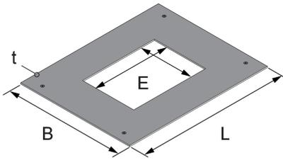
Das Bauteil UBSFMD4 V ist ein Montagedeckel für den Estrichbündigen Kanal UBSF zur Bestückung von eckigen Einheiten. Er ist aus feuerverzinktem Stahlblech gefertigt, hat eine Länge von 500 mm und ist in den Breiten 200 bis 600 mm erhältlich. Das Bauteil entspricht der DIN EN 50085 – der europäischen Norm für Elektroinstallationskanalsysteme, und ist vom VDE geprüft und zertifiziert.
