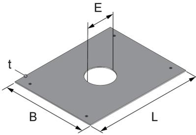
Das Bauteil UBSFMD4 R ist ein Montagedeckel für den Estrichbündigen Kanal UBSF zur Bestückung von runden Einheiten. Er ist aus feuerverzinktem Stahlblech gefertigt, hat eine Länge von 500 mm und ist in den Breiten 200 bis 600 mm erhältlich. Das Bauteil entspricht der DIN EN 50085 – der europäischen Norm für Elektroinstallationskanalsysteme, und ist vom VDE geprüft und zertifiziert.
