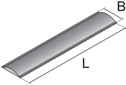
Bei den Beschriftungsstreifen UBS handelt es sich um Zubehörteile aus dem Portfolio der Gerätebecher und Installationsgeräte. Die Streifen sind seitlich geöffnet, so dass sich ihr Blanko-Einsteckschild leicht entfernen, beschriften und wieder einfügen lässt. Mithilfe der selbstklebenden Rückseite können sie schnell und unkompliziert auf allen Abdeckplatten angebracht werden. Die Beschriftungsstreifen werden aus sendzimir-feuerverzinktem Stahlblech gefertigt.
