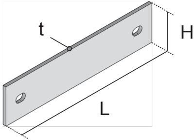
Bei den Bauteilen UBKPRV handelt es sich um Verbinder für estrichbündige Schwerlastkanäle. Sie werden dazu verwendet, die Seitenprofile an den Stoßstellen miteinander zu verschrauben. Die Artikel sind aus sendzimir-feuerverzinktem Stahlblech gemäß DIN EN 10346 gefertigt und in einer Länge von 150 mm, einer Höhe von 35 mm, einer Materialstärke von 3 mm erhältlich.
