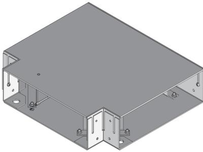
Der T-Abzweig UBEBAIR ist ein Bauelement aus dem Sortiment des estrichbündigen Bürstenkanals CHALI. Diese Produktlösung dient als Verbindungsstück zwischen zwei Kanalteilen. Dank ihrer T-Form können Leitungen innerhalb eines Kanalabschnitts entsprechend der gewünschten Richtung verlegt werden. Das Bauelement ist aus sendzimir-feuerverzinktem Stahlblech gemäß DIN EN 10346 gefertigt
