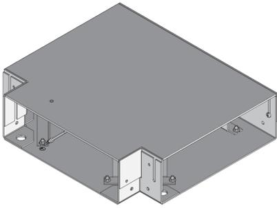
Der T-Abzweig UBEEMAIL ist ein Bauelement aus dem Sortiment des estrichbündigen Bürstenkanals CHALI. Diese Produktlösung dient als Verbindungsstück zwischen zwei Kanalteilen. Dank ihrer T-Form können Leitungen innerhalb eines Kanalabschnitts entsprechend der gewünschten Richtung verlegt werden. Das Bauelement ist aus sendzimir-feuerverzinktem Stahlblech gemäß DIN EN 10346 gefertigt..
