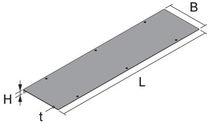
Bei den Baukomponenten UBEEDDL handelt es sich um ein verschraubbares Blinddeckel-Set für das estrichbündige Kanalsystem CHALI. Verwendbar für die CHALI-Bodenwanne und bei Türquerungen im Austausch mit einem Scharnierdeckel. Diese Produktlösung wird aus sendzimir-feuerverzinktem Stahlblech nach DIN EN 10346 gefertigt. Die Produktlösung ist für gängige Bürolasten ausgelegt. Das Set wird inklusive sechs galvanisch-verzinkter (gemäß DIN EN ISO 4042) Senkkopfblechschrauben BSS 4.8 x 16 geliefert.
