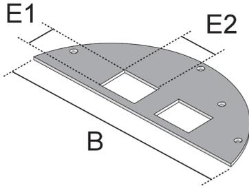
Bei den Bauelementen UBE KS aus dem Portfolio der Unterflursysteme handelt es sich um halbrunde Abdeckplatten mit zwei rechteckigen Aussparungen. Die Einbauplatten für Datentechnik, bestückt mit zwei Keystone-Datenmodulen, können in die BODO Gerätebecher eingeschraubt werden. Die Abdeckplatten sind aus sendzimir-feuerverzinktem Stahlblech nach DIN EN 10346 gefertigt. Das Einbaumaß E1 liegt bei 14,9 mm und das Einbaumaß E2 beträgt 19,5 mm.
