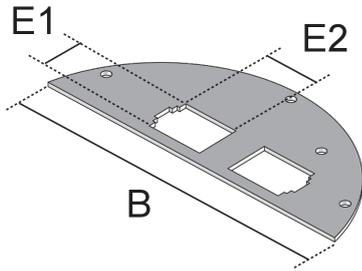
Bei den Bauelementen UBE BTR aus dem Portfolio der Unterflursysteme handelt es sich um halbrunde Abdeckplatte mit zwei Aussparungen. Die Einbauplatten für Datentechnik, bestückt mit zwei BTR-Datenmodulen, können in die BODO Gerätebecher eingeschraubt werden. Die Abdeckplatten sind aus sendzimir-feuerverzinktem Stahlblech nach DIN EN 10346 gefertigt. Das Einbaumaß E1 liegt bei 15 mm, das Einbaumaß E2 beträgt 19,5 / 21,7 mm.
