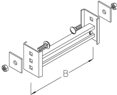
Die Sprossen STIS werden im Zuge der Steigetrassenmontage eingebaut und mit dem Seitenholm verschraubt. Sie eignen sich für die Steigetrassen ST 81. Die Sprossen haben eine der Steigetrassenbreite entsprechende Breite von 200 bis 1200 mm und bestehen aus tauchfeuerverzinktem Stahl.
