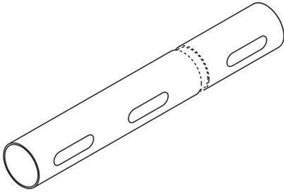
Das Schutzrohr SRL mit Langlöchern dient der sicheren und schonenden Ein- und Ausführung von Kabeln aus Kabelrinnen und -leitern. Es steht mit einer Länge von 6000 mm sowie mit einem Durchmesser von 60 mm zur Verfügung. Verschiedene Materialien und Oberflächen sorgen dafür, dass die Korrosionsschutzanforderungen unterschiedlichster Anwendungsgebiete erfüllt werden.
