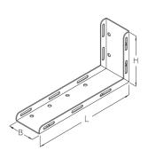
Der Fußwinkel SRFW mit Langlöchern dient zusammen mit der Schelle SRS-B der Befestigung des Schutzrohrsystems am Baukörper und der sicheren Ein- und Ausführung von Kabeln. Er hat eine Länge von 200 oder 400 mm. Verschiedene Materialien und Oberflächen sorgen dafür, dass die Korrosionsschutzerfordernisse unterschiedlichster Anwendungsgebiete erfüllt werden.
