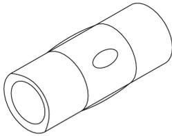
Die Spannhülse SP ist ein wesentlicher Bestandteil der Spannverbindung JSV, die eine zug- und druckfeste Verbindung zwischen zwei Betonbauteilen herstellt. Je nach Größe der Spannverbindung ist die Spannhülse SP mit Rechts-/Linksgewinde und Sichtloch in verschiedenen Größen erhältlich.
