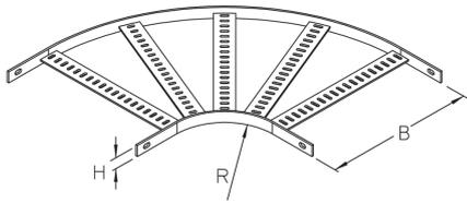
Der Schiffleiter-Bogen SLB ermöglicht horizontale Richtungsänderungen der Kabelführung um 90°. Er eignet sich für Schiffskabelleitern SKL mit einer Holmhöhe von 30 mm und weist Breiten von 75 bis 500 mm auf. Der Bogen wird mithilfe von separat zu bestellenden Verbindern SLV an den Leitern montiert. Verschiedene Materialien und Oberflächen sorgen dafür, dass unterschiedliche Korrosionsanforderungen erfüllt bzw. weitere Schutzmaßnahmen getroffen werden können.
