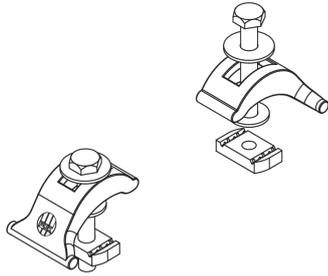
Das Trägerklemmenset SKS A ist mit den Montageschienen A 41 sowie KHA 21, 41, 42 und 82 kombinierbar. Es dient der Befestigung von Konsolträgern an Stahlträgern. Das Set ist bis max. 20 kN belastbar. Der Klemmbereich erstreckt sich von 10 - 30 mm. Verschiedene Materialien und Oberflächen sorgen dafür, dass die Korrosionsschutzanforderungen unterschiedlichster Anwendungsgebiete erfüllt werden.
