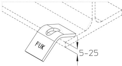
Die leichte Spannklaue SKLL dient der Befestigung von Kabelrinnen und Weitspannbahnen an Stahlträgern. Bei Letzteren ist die zusätzliche Verwendung von Weitspannholmstützen (WPHS) nötig. Der Klemmbereich erstreckt sich von 5 - 25 mm. Verschiedene Materialien und Oberflächen sorgen dafür, dass die Korrosionsschutzanforderungen unterschiedlichster Anwendungsgebiete erfüllt werden.
