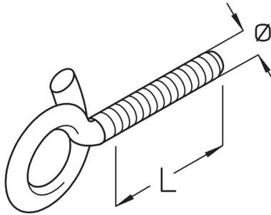
Der Schaukelhaken SHS dient zusammen mit der Knotenkette der Abhängung von Lichtbandsystemen, Gitterbahnen und Kabelrinnen. Er steht in Gewinden M6 und M8 zur Verfügung und besteht aus galvanisch verzinktem Stahl. Die maximale Belastung liegt bei 0,4 kN.
