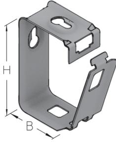
Der Sammelhalter SH QS dient der flexiblen und kostengünstigen Führung von Installationsleitungen oder kleineren Kabelbündeln an Wand oder Decke. Er ist 66 bzw. 92 mm hoch und für eine maximale Belastung bis 1,50 bzw. 3 kg/m ausgelegt. Der Sammelhalter besteht aus sendzimir-feuerverzinktem Stahl und ist entsprechend geeignet für die Verwendung im Funktionserhalt E30-E90. Die Montage muss mit Befestigungselementen erfolgen, die für den Brandschutz zugelassen sind.
