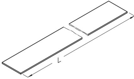
Das Spannband SD E dient zusammen mit dem Spannschloss SC und der Grundplatte GP dazu, einen Befestigungspunkt mit Gewinde M8 an einer Konstruktion herzustellen (z.B. Mast oder Rohr). Das Spannband SD E steht in den Längen 1000 und 50.000 mm zur Verfügung. Die zulässige Zugkraft beträgt  $< 2,0$  kN. Das Spannband besteht aus Edelstahl.
