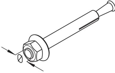
Der Spreizdübel SD-BS dient der Befestigung von Tragkonstruktionen wie Konsolhaltern oder Wandkonsolen an Wand und/oder Decke. Er ist als Einzelbefestigung zulässig bei gerissenem und ungerissenem Normalbeton mit der Festigkeit  $\geq C20/25$ . Die Herstellerangaben sind zwingend einzuhalten (ETA-19/0520). Durch die vormontierte Unterlegscheibe ist der Spreizdübel für die Befestigung von Stahlbauteilen mit Langlöchern geeignet.
