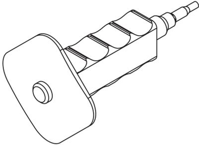
Der Einschlagdorn SAZ-D ermöglicht das schnelle, manuelle Setzen von Schlagankern SA. Die Herstellerangaben sind zwingend einzuhalten. Er besteht aus galvanisch verzinktem Stahl und ist in den Durchmessern 8, 10 und 12 mm verfügbar.
